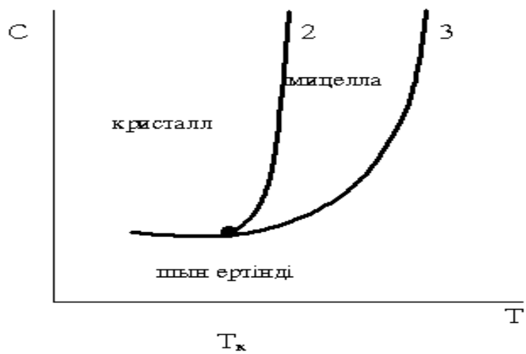
Иондық БАЗ-дың ерітіндісінің фазалық диаграммасы. 1 қисық – кристалл/ерітінді, 2 қисық – кристалл-мицелла, 3 қисық – мицелла-ерітінді тепе-теңдіктеріне сәйкес
